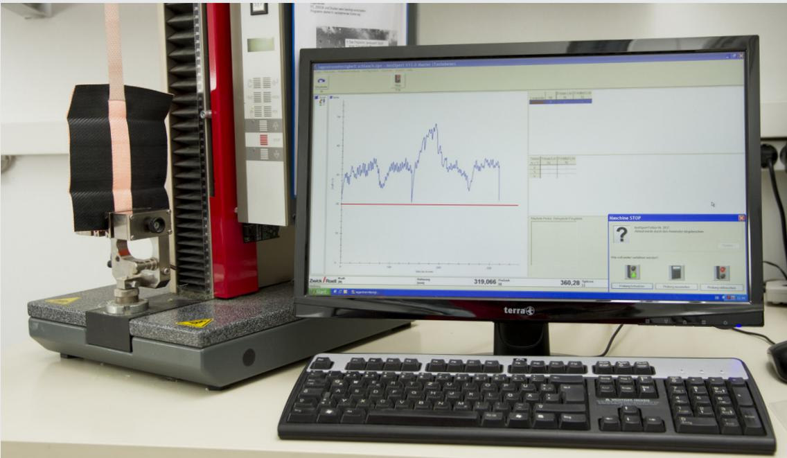
Ein wesentliches Qualitätskriterium ist die Haftung zwischen Gewebe und Innenauskleidung. Dieser Haftwert ist zumeist auch entscheidend über die Langlebigkeit eines Schlauches. Geringe Haftwerte führen zum Ablösen der Dichtschicht in Anwendung und Lagerung und somit zum frühzeitigen Versagen der Schlauchkonstruktion.
